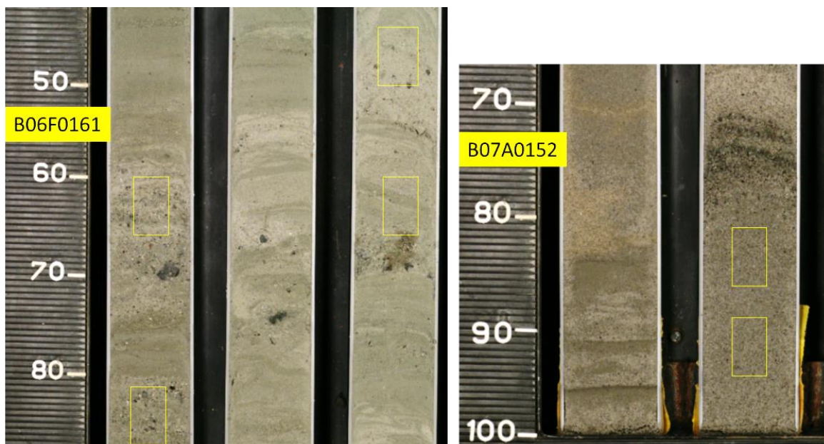
Figuur 33. Zichtbare verschillen tussen fluvioglaciale grove zanden: rommelig en relatief slecht doorlatend in boring B06F0161 (Kommerzijl, Gr.), gelijkmatig en goed doorlatend in boring B07A0152 (Groot Wetsinge, Gr.).
