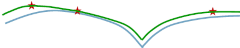
Figuur 7: Toelichting berekening op basis van een dwarsdoorsnede over een watergang: De sterren zijn de metingen, de blauwe lijn is het referentievlak, de groene lijn is de berekende stijghoogte (referentievlak + ruimtelijk geïnterpoleerde verschillen)
